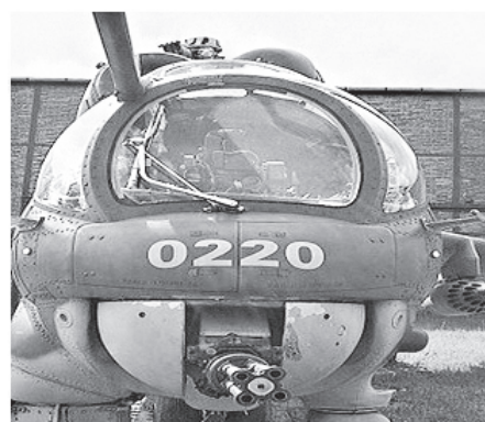
Рис. 3. Примеры применения прозрачной брони для защиты экипажей боевых вертолётов и самолётов
