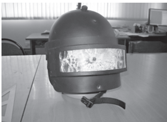
Рис. 4. Шлем «Рысь» с кварцевым стеклом
