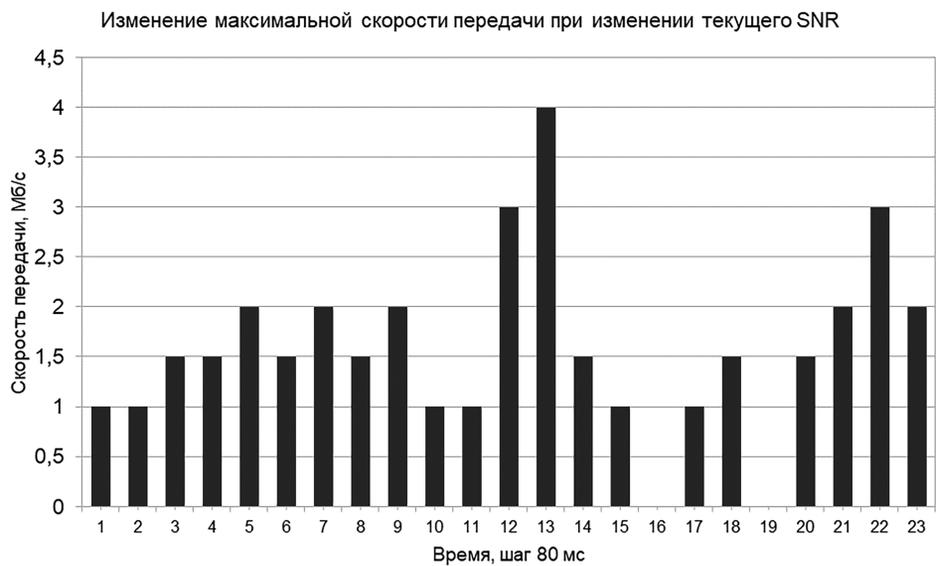
Рис. 5. Изменение максимальной скорости передачи при изменении текущего SNR в канале TPC, Мб/с
