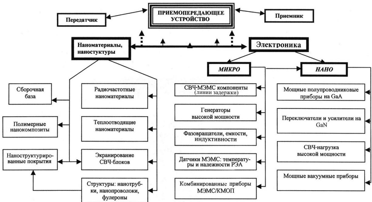
Рис. 3. Структурная схема возможных направлений применения наноматериалов и электроники в приемопередающих устройствах РЛС
