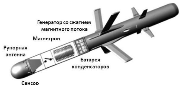
Рис. 3. Устройство ПТУР с генератором мощного электромагнитного импульса
