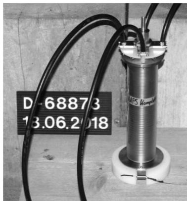
Рис. 4. Прототип генератора мощного электромагнитного импульса (ЭМИ) [16]
