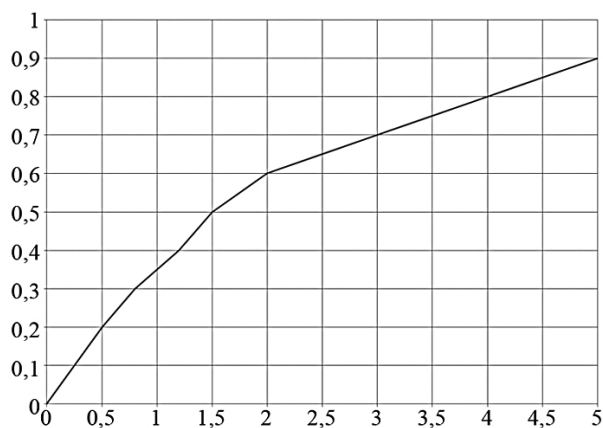
Рис. 10. Зависимость полноты сгорания частиц бора в камере дожигания без распределенного подвода воздуха
