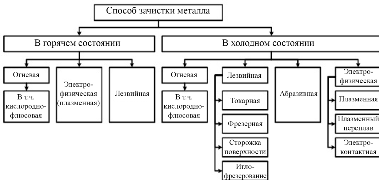
Рис. 5. Классификация методов зачистки металлических поверхностей
